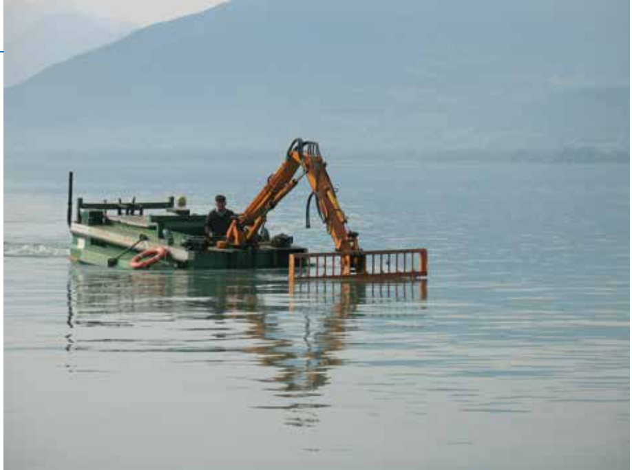
Photo 1 – Traitement préventif de certaines plages du lac d'Annecy. Le véhicule amphibie est équipé à l'avant d'une herse qui «griffe» la couche superficielle du fond, et détruit jusqu'à 80 % des mollusques hôtes intermédiaires du parasite (© L. Renaud – SILA)
