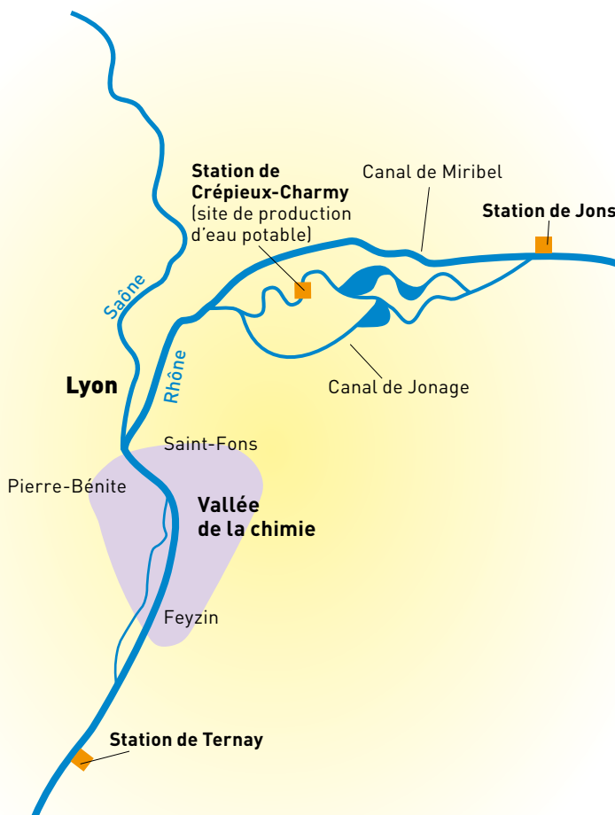
Le dispositif d'alerte, de surveillance et de suivi de la qualité des eaux du Rhône dans l'agglomération lyonnaise.
