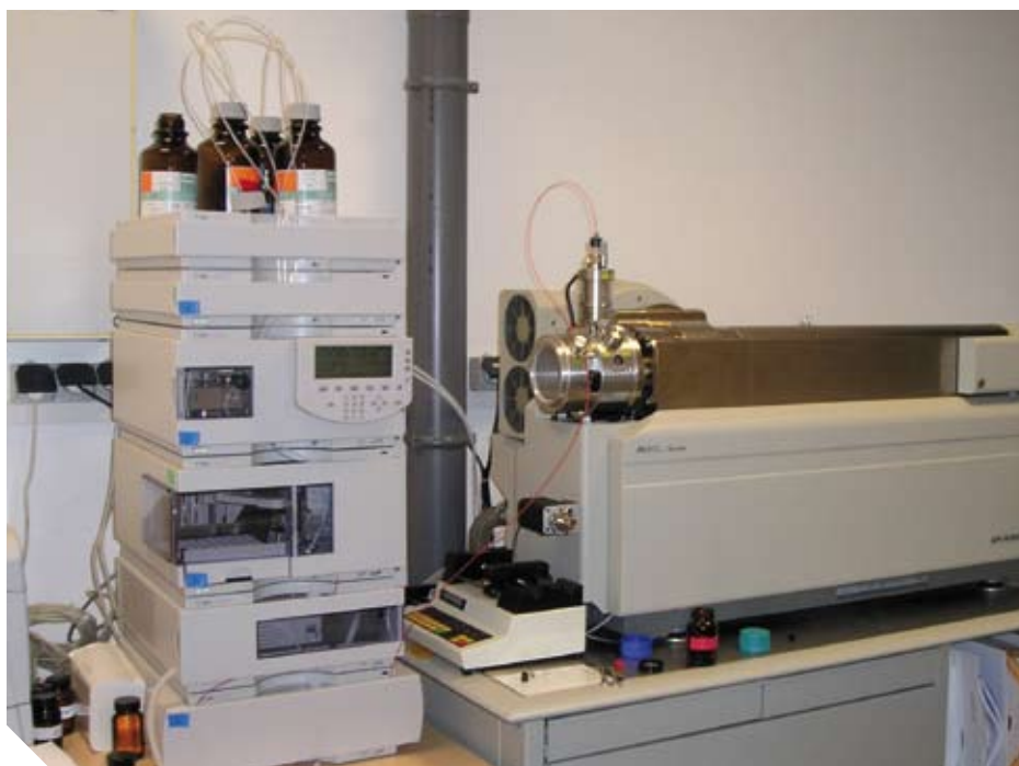
Chromatographie liquide couplée à la spectrométrie de masse en tandem (LC-MS-MS) (© P. Bados, Cemagref)
