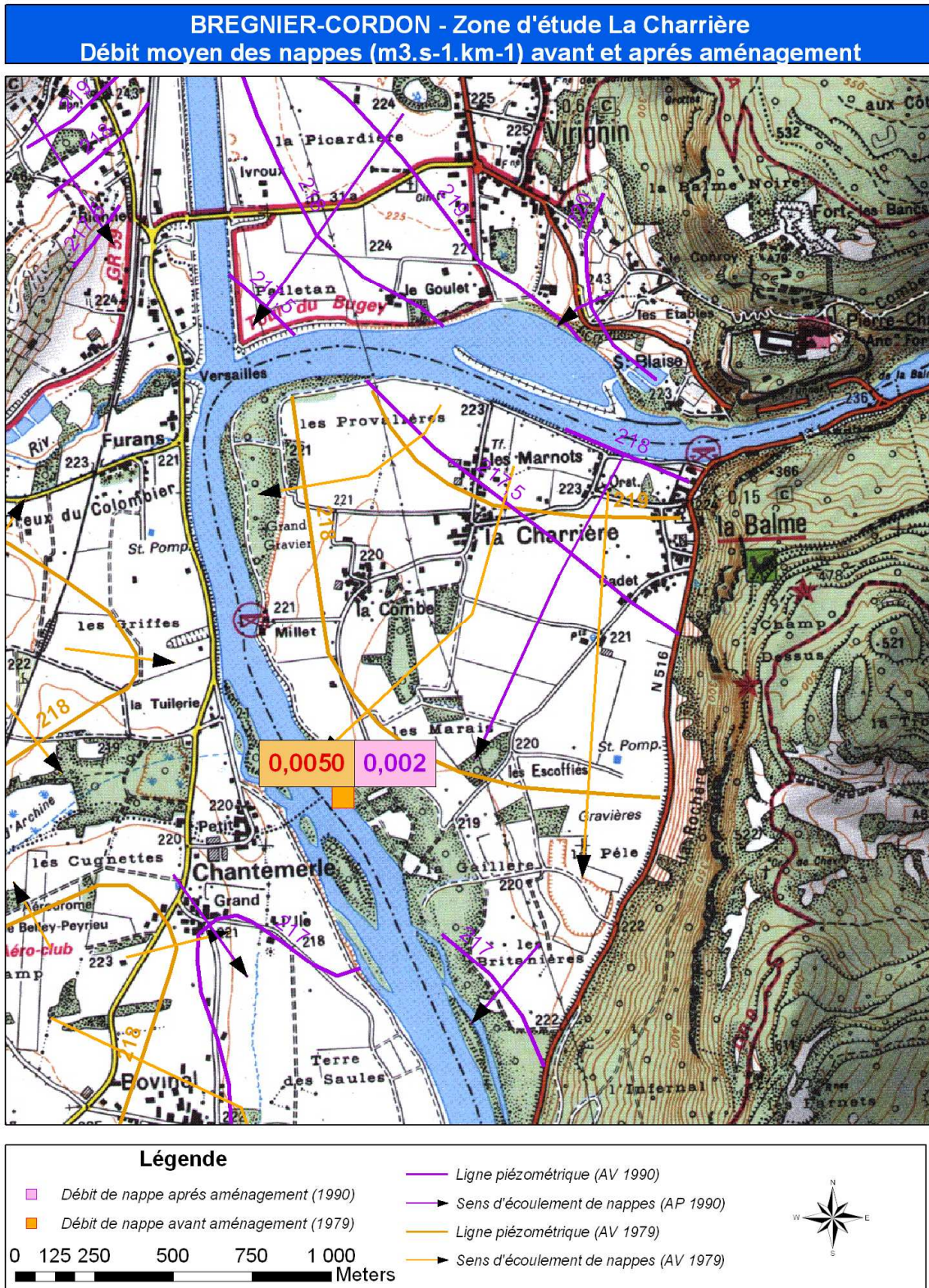
Figure 55. Débits de nappe évalués avec la formule de Darcy au niveau du secteur de La Charrière Les débits de nappes sont exprimés en m 3 /s/km
