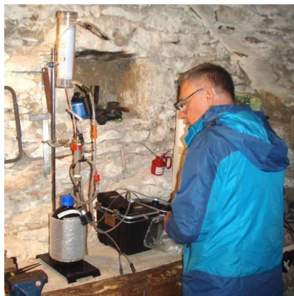
Photo 1 : Système de mesure du 222 Rn à partir de prélèvement par bouteille.
