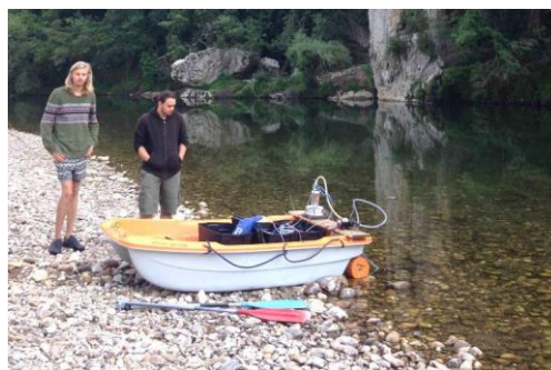
Photo 2 : embarcation équipée pour l'analyse du 222 Rn en continue (pompe visible sur l'arrière)
