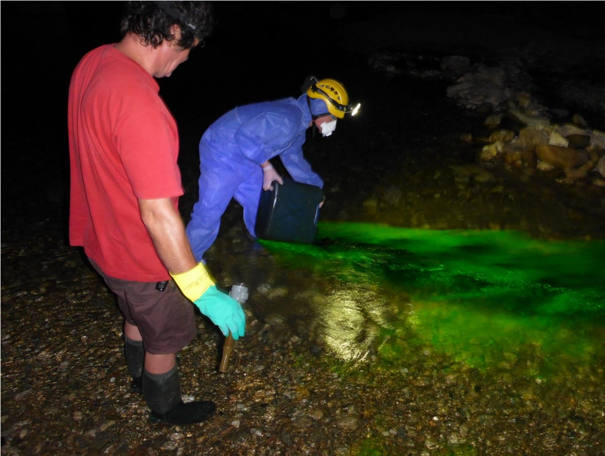
Injection de 10 kg de fluorescéine dans la Cèze, au niveau du pont de Rivières soit 500 m environ en amont de la coupure des écoulements superficiels, le 21 juillet 2015 à 00h00 (photo : Jordan Ré-Bahuaud)
