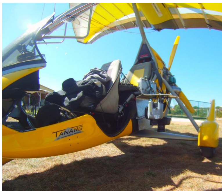
Figure 42 : ULM supportant la caméra thermique (VarioCAM® hr research – Infratec) (Photo : V. Wawrzyniak)
