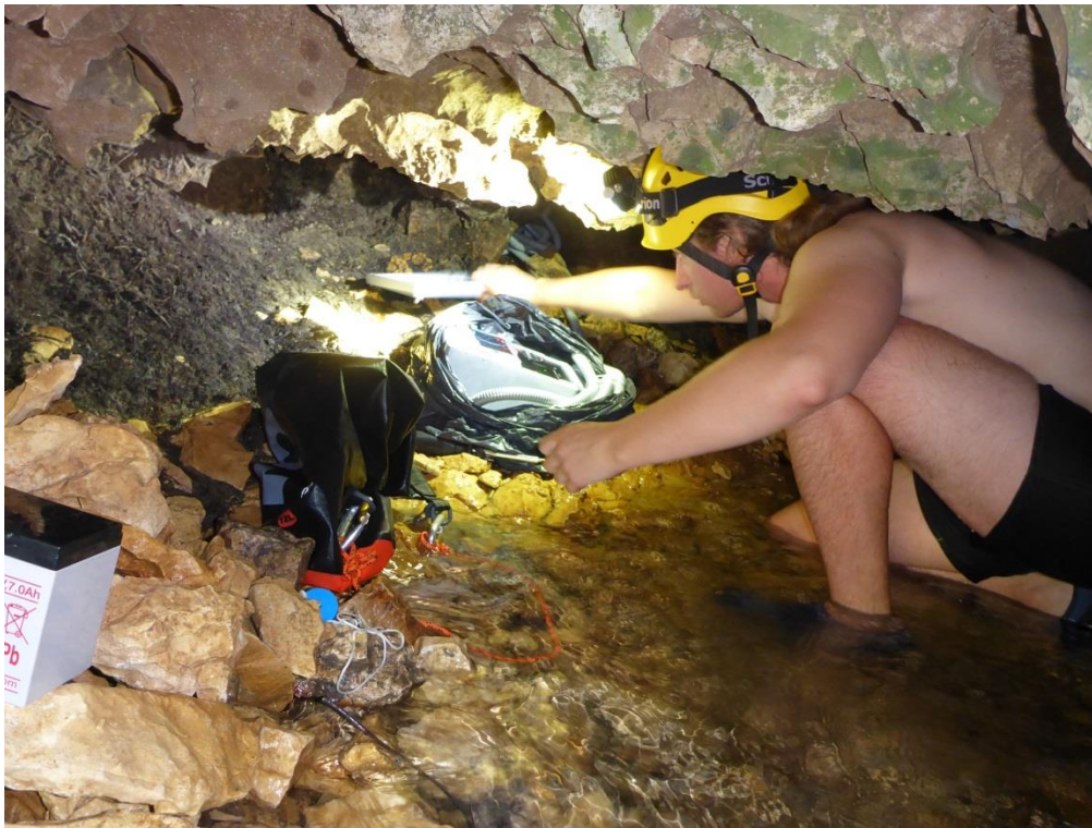
Équipement de la source Font Canet par un fluorimètre de terrain et deux fluocapteurs (photo : Joël Jolivet)
