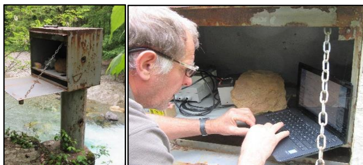
FIG.3.8 — Puits du limnigraphe sur le Galeizon à l'Aube morte, abritant l'équipement de mesure Solophème (GAUCHE) ; sonde dans le puits du limnigraphe, centrale Solophème et récupération du fichier de données (DROITE)
