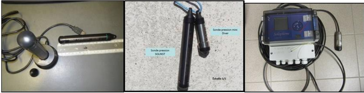
FIG.3.7 — (GAUCHE) SONDES SOLINST : LEVELOGGER (DANS LE SABOT DE TRANSFERT DE DONNÉES) ET BARO ; (CENTRE) MINIDIVER ; (DROITE) SONDE DE PRESSION ET CENTRALE SOLOPHÈME
