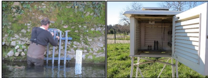
FIG.3.9 — TEST DES SONDES NEUVES SOLINST AVANT LEUR INSTALLATION SUR SITE AU PRINTEMPS 2018 (GAUCHE : LEVELOGGER ; DROITE : BAROLOGGER)
