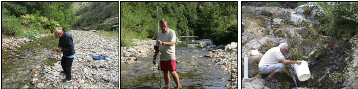
FIG.3.14 — JAUGEAGE PAR DILUTION (GAUCHE) ; MESURE DE VITESSE (CENTRE) ; EMPOTEMENT (DROITE)
