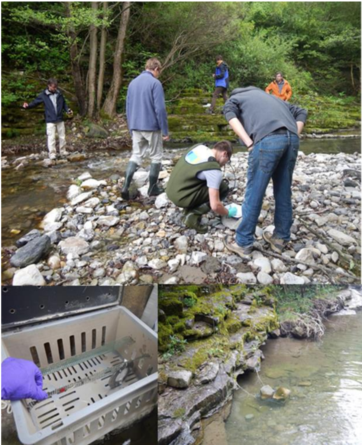
ANNEXE 2 : Illustration d'une campagne de mesure avec des suivis physico-chimiques par sondes multi-paramètres (haut) et installation sécurisée en rivière des systèmes POCIS pour la mesure temporellement intégrée des concentrations en produits pharmaceutiques et pesticides (bas)
