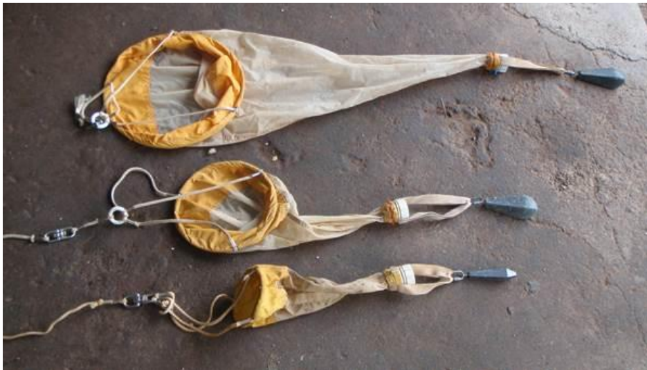
Illustration 16 : Equipement nécessaire pour un pompage dans des puits dont la profondeur total (>17m) ou le niveau piézométrique (>8m) ne permettent pas l'utilisation d'une pompe manuelle (© P. Marmonier)
