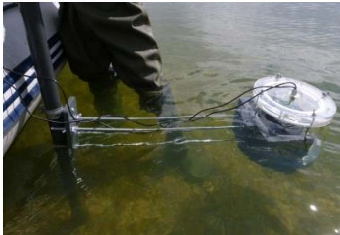
Figure 4 : Dispositif d'acquisitions photographiques sous l'eau.
