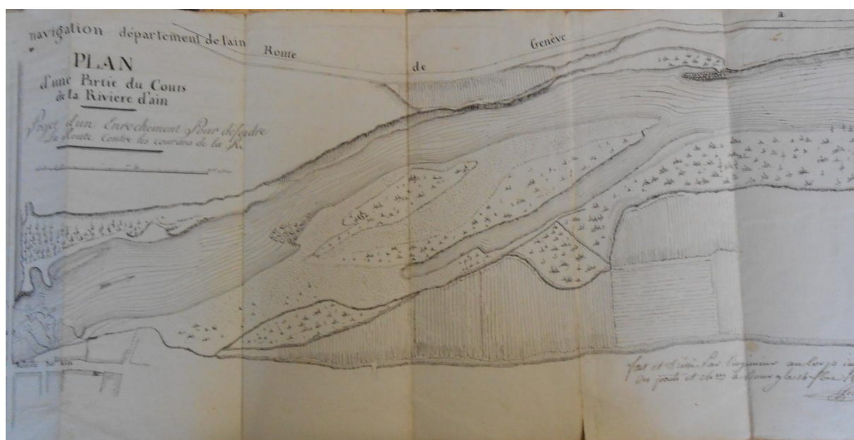
Photographie 4. Tracé du cours de la rivière d'Ain et projet d'encrochement (service des Ponts et Chaussées, 14 septembre 1810) 8
