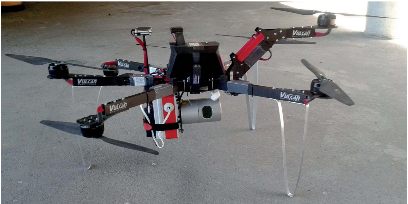
Fig. 3 : Plateforme LiDAR / Drone
