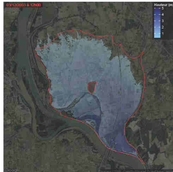
Pic de crue simulé/observé (Diren 2005)
