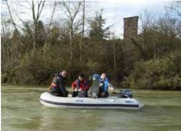
Jaugeage d'une crue à Chazey (stage ADCP 2009, Dreal RA / Cemagref / CNR)
